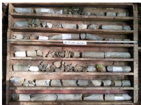
图 4 实例 1 中 B-7 孔段片麻岩的岩芯照片 Fig.4 Photo of gneiss core in segment B-7 of example 1
