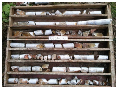
图 3 实例 1 中 A-3 孔段白云质大理岩的岩芯照片 Fig.3 Photo of dolomite marble core in segment A-3 of example 1
